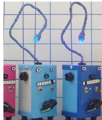
Los robots no necesitan ser construidos con mecanismos digitales. Uno también puede crear mecanismos de control usando circuitos analógicos. La foto a la derecha muestra dispositivos llamados Thingamapoops ([bleeplabs.com](http://bleeplabs.com)). ¿Qué hacen? Pueden ser usados para producir o sintetizar bips que suenan muy locos. Los bips también pueden ser enviados como entrada para instrumentos musicales estándar para crear aún más sonidos y efectos bizarros.
