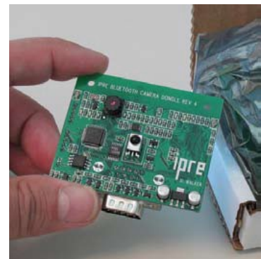
El Fluke Dongle le agrega Bluetooth y otras capacidades al Scribbler.
