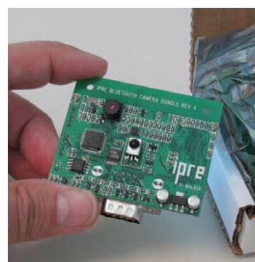
El Fluke Dongle le agrega Bluetooth y otras capacidades al Scribbler.
